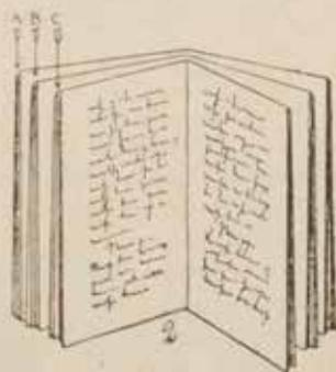
Fig. 46 — Livro encartado. As letras A B C indicam três cadernos colocados um dentro do outro.
