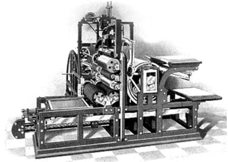
3. A primeira prensa plano-cilíndrica, construída por Koenig e Bauer em 1811, para o *The Times*.
