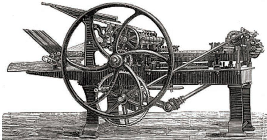
2. A *Presse Simplifiée*, impressora plano-cilíndrica concebida e construída por Wibart, em 1878.
